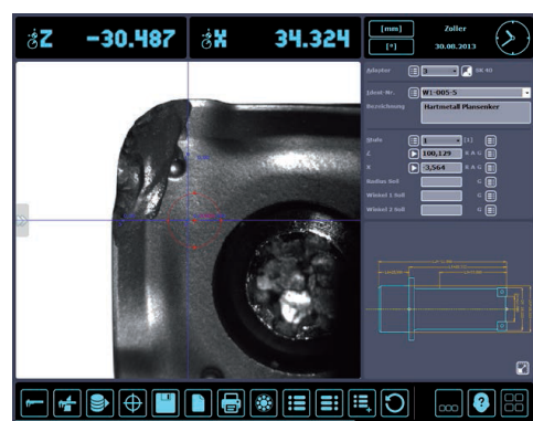
Funkcje projektora i inspekcja ostrza skrawającego do pomiaru i kontroli zużycia ostrza
