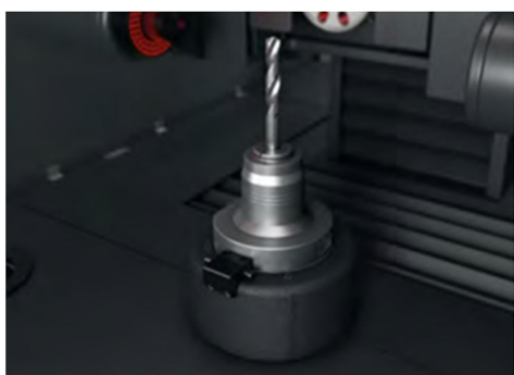
Wrzeciono »a.c.e.« z mechanicznym zaciskiem wraz z hydraulicznym adapterem gwarantuje powtarzalność zamocowania narzędzia poniżej 1µm
