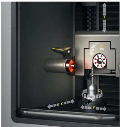
5 osi sterowanych numerycznie pozwalająca pomiar kompleksowej geometrii narzędzi skrawających
