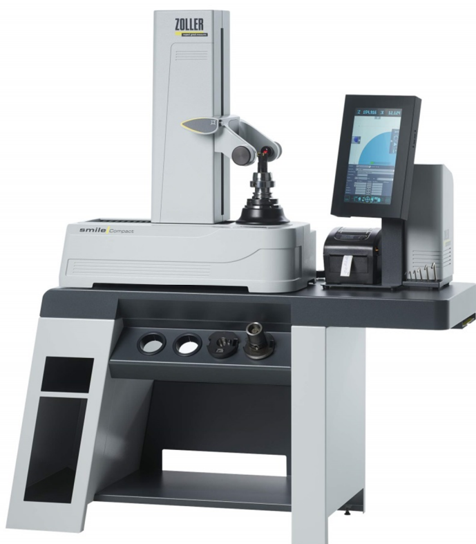
ZOLLER-»smileCompact« z systemem obróbki obrazu »pilotStarter« w wersji ze stolikiem
