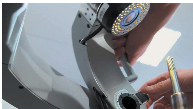
Rys. 1. Kamera uchylna do kontroli geometrii ostrza
