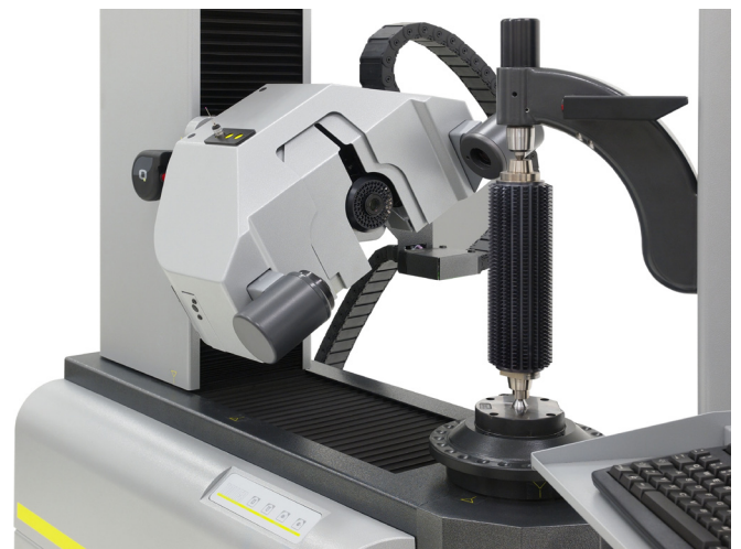
Przyrząd do pomiaru frezów obwiedniowych „hobCheck”
