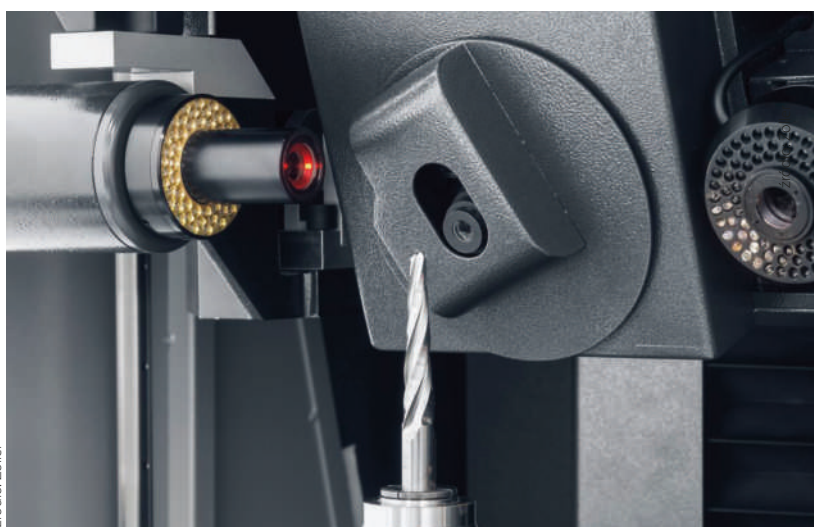
Ilustracja 2: Uchylony statyw kamery przy pomiarze gwintownika w maszynie »genius 4«
