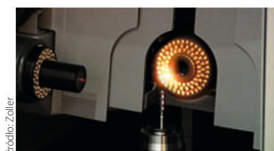
Ilustracja 2: Uchylony statyw kamery przy pomiarze gwintownika w maszynie »genius 4«
